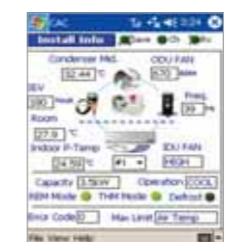
A telepítési állapot ellenőrzése
